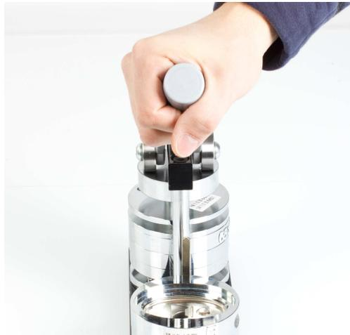
**Nota:** Dopo un lungo utilizzo della macchina per spille può verificarsi uno spostamento del dispositivo, questo può essere regolato con un cacciavite a lama cruciforme.
