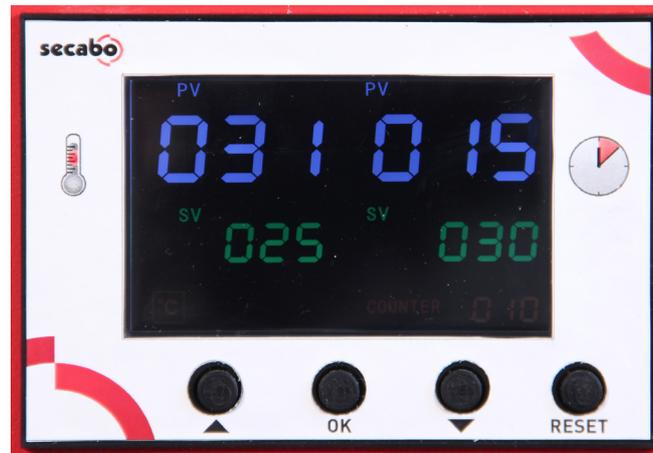
El controlador central permite manipular la temperatura deseada ( $^{\circ}\text{C}$  o  $^{\circ}\text{F}$ ) y la presión del tiempo en segundos. Los dígitos verdes representan los valores nominales, mientras que los números blancos reflejan los valores reales. En la parte inferior derecha de la pantalla, se indica el número de prensados realizados desde la última puesta en cero.
