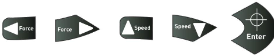
Um den korrekten Ausgangspunkt zum Plotten zu setzen, bewegen Sie im Offline-Modus den Messerkopf und die Folie so, dass sich das Messer in der vorderen rechten Ecke der Folie befindet. Bestätigen Sie nun diesen Nullpunkt durch Drücken des Fadenkreuzes, dadurch wechselt das Gerät auch automatisch in den Online-Modus.
