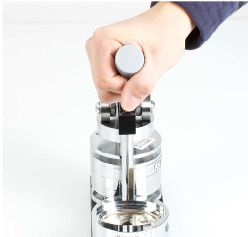
**Hinweis:** Nach längerem Gebrauch der Buttonmaschine kann es zu einer Verstellung der inneren Anschläge der Formwerkzeuge kommen, diese können mittels Kreuzschlitzschraubenzieher ggf. nachjustiert werden.
