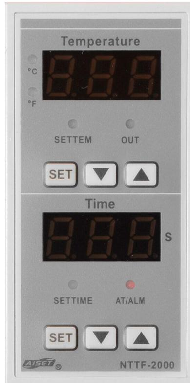
El control central permite establecer la temperatura deseada (°C y °F), así como la duración de prensado en segundos.
