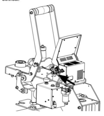
Coloque la membrana calefactora de la Secabo SH7 Softheat delante de la conexión de brida debajo de la palanca de presión de la Secabo TS7 Smart en cierto ángulo y enrosque
