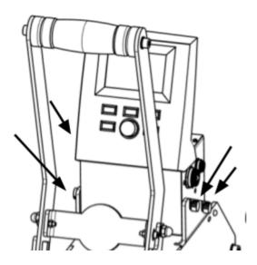
Luego, conecte el control neumático de la Secabo SH7 Softheat a los pernos roscados independientes, vistos desde la parte delantera derecha. Fije el control neumático a los pernos roscados usando las dos tuercas moleteadas previamente retiradas. Apriete otra vez las tuercas moleteadas del lado izquierdo.
