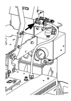
Luego, conecte la membrana calefactora de la Secabo SH7 Softheat al control neumático de la Secabo SH7 Softheat utilizando la manguera de aire comprimido (8 mm) incluida en el suministro. Para hacerlo, debe conectar la manguera de aire comprimido tanto a la membrana calefactora Secabo SH7 Softheat como al control neumático Secabo SH7 Softheat utilizando los neumáticos/pneufits suministrados.
