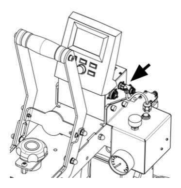
Ahora conecte el conjunto de cables de la Secabo TS7 Smart con el pequeño enchufe de 6 pines, que viene del electroimán, al adaptador del control neumático de la Secabo SH7 Softheat.
