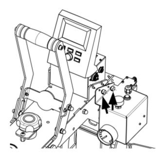
Conecte el conjunto de cables del control neumático de la Secabo SH7 Softheat al pequeño enchufe del controlador HPC01.
