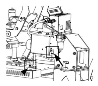
Ahora conecte la manguera de aire comprimido (6 mm) a la conexión para el suministro externo de aire comprimido. Hágalo utilizando el Neumático/Pneufit en el reductor de presión. En el último paso, conecte el otro extremo al suministro externo de aire comprimido, donde la presión de entrada no debe superar un máximo de 8 bares. Utilice únicamente el material de conexión suministrado para evitar daños materiales en la máquina.
